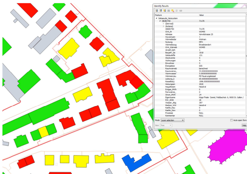
Abbildung 5 zeigt eine Visualisierung der Heizungssysteme von Gebäuden und die dazugehörigen Gas- bzw. Fernwärmeleitungen (grün – Fernwärme, rot – Heizöl, gelb – Gas, grau – unbeheizt, blau – Umweltwärme, violett – Elektroheizung (Kirche)).
